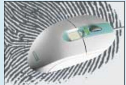
Mouse mit einem Fingertipp-Sensor ausgestattet. 65.000 Sensorelemente auf diesem 1,7 cm<sup>2</sup> großen Chip erfassen dazu Details eines Fingerabdrucks. Mit Hilfe biometrischer Verfahren werden bei der Authentifizierung die individuellen Merkmale auf der Berg- und Tallandschaft eines Fingers – also z. B. Verlauf und Länge eines „Tales“, Verzweigungen oder Wirbel – erkannt und mit den gespeicherten individuellen Daten der Berechtigten abgeglichen.
